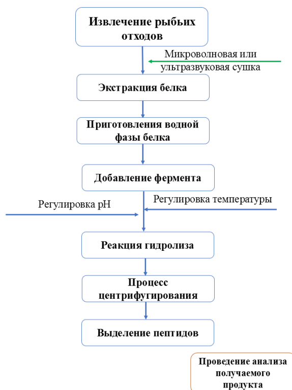
Рисунок 2. Схема получение биопептидов на основе метода ферментативного гидролиза пищевых белков
