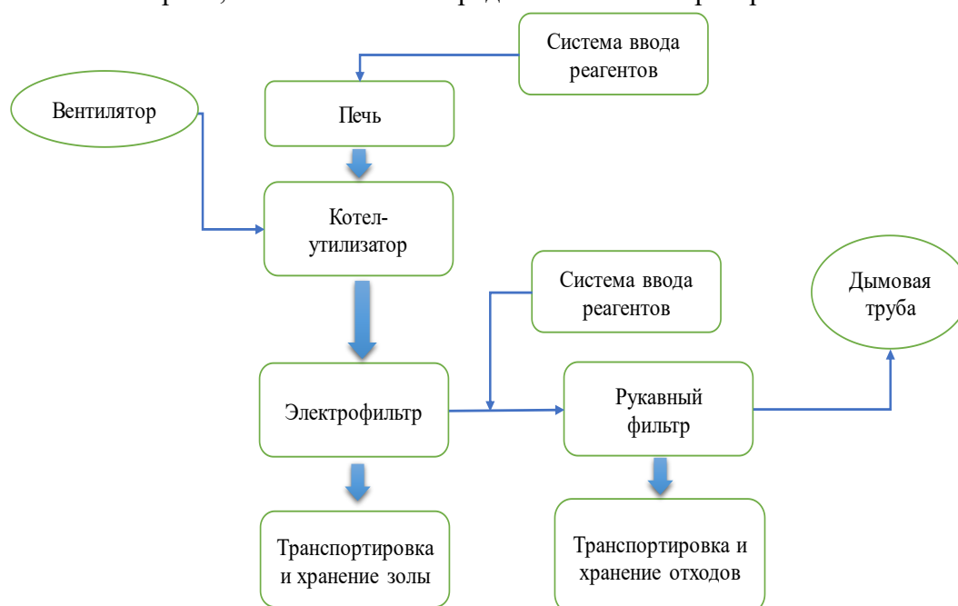
Рисунок 2. Система газоочистки на Северной станции аэрации
