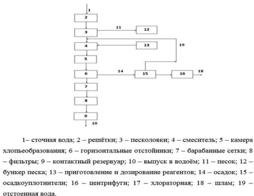
Рисунок 3. Технологическая схема очистной станции с физико-химической очисткой сточных вод
